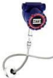
Level Plus® - датчики уровня жидкости используют все преимущества заложенные в магнитострикционные технологии, чтобы измерить уровень жидкости, уровень интерфейса и температуру внутри всего лишь через одно отверстие. Точное измерение нескольких переменных параметров процесса из одного отверстия снижает установленные затраты на получение обратной связи из резервуара хранения или технологического аппарата.
